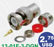
13-01F-3-DGN Conector BNC Macho con anillo para enroscar p/cable RG58A/U, LMR@195 y pin bañado en oro y aislante Delrin (polímero) 2.75 USD
