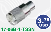
17-06B-1-TSSN Conector UHF Macho con anillo para enroscar p/cable 213/U, RG8A/U, cuerpo y pin bañado en plata y aislante de teflón 3.75 USD
