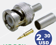
13-10F-DGN Conector BNC Macho con anillo de presión p/cable RG58A/U, CNT 195, LMR@195, pin bañado en oro y aislante Delrin (polímero) 2.30 USD
